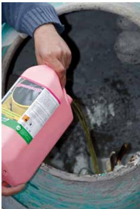
Diluire Betonflash con acqua, nel rapporto prodotto:acqua che va da 1:10 a 1:1, a seconda delle necessità e della tipologia di sporco da rimuovere. Nel caso di betoniere si può versare direttamente il prodotto dopo aver messo la quantità di acqua desiderata dentro la stessa.
