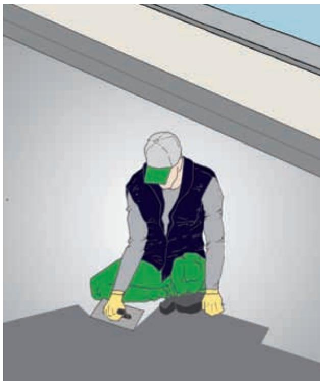
5) Procedere alla stesura del Flex Car sulla superficie orizzontale mediante l'utilizzo di una spatola liscia di acciaio. Avendo cura di rasare a zero in modo che la dimensione del quarzo sia lo spessore del rivestimento.
