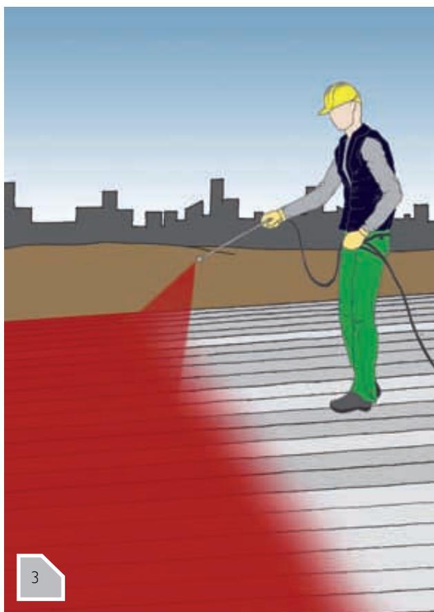
1) Dopo aver pulito la superficie si può procedere all'applicazione del Protect Fix, in ragione di 250 gr/mq.
