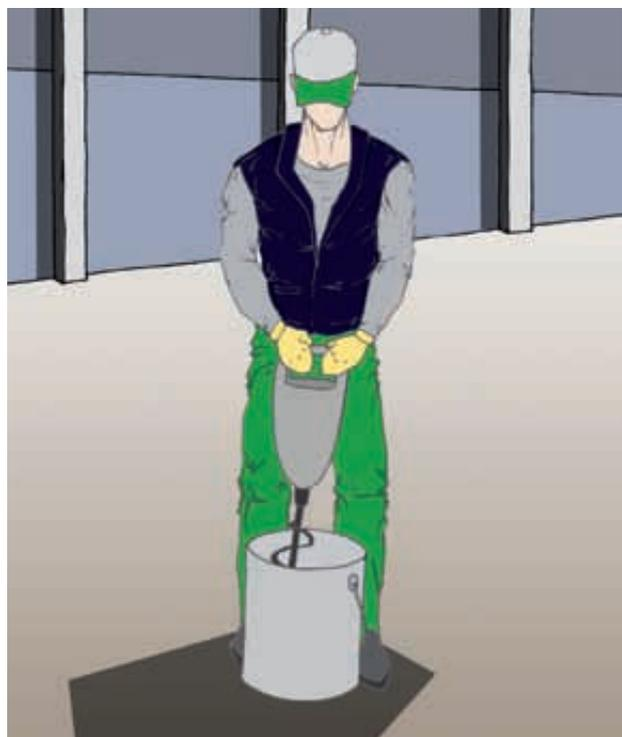
2) Versare il componente B nel componente A e mescolare accuratamente con apposito mescolatore munito di girante. Applicare la prima mano di prodotto diluendolo con 5-10% di Solvetan.
