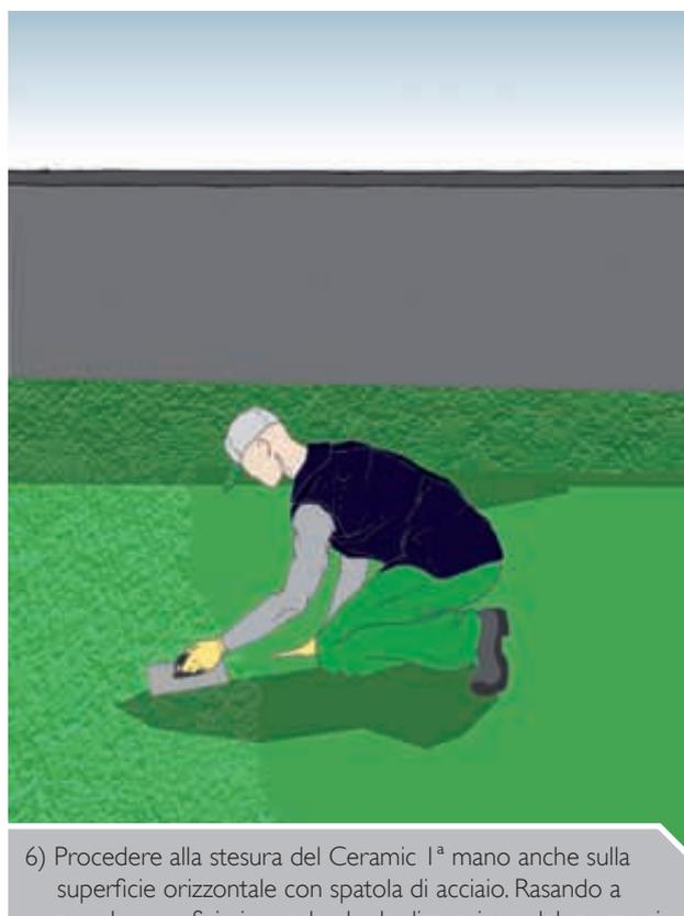
6) Procedere alla stesura del Ceramic 1<sup>a</sup> mano anche sulla superficie orizzontale con spatola di acciaio. Rasando a zero la superficie in modo che la dimensione del quarzo sia lo spessore del rivestimento.
